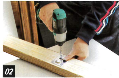
木材に金属プレートを固定。なお、柱として使う場合、プレートの取り付け位置は床から1500mmの高さを推奨している
